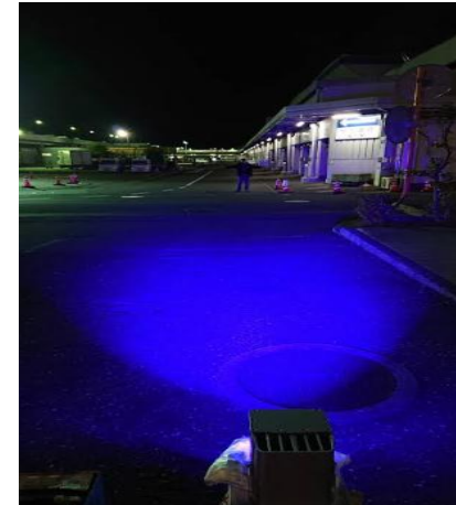
(屋外での光直距離試験 約 5 m実績)
